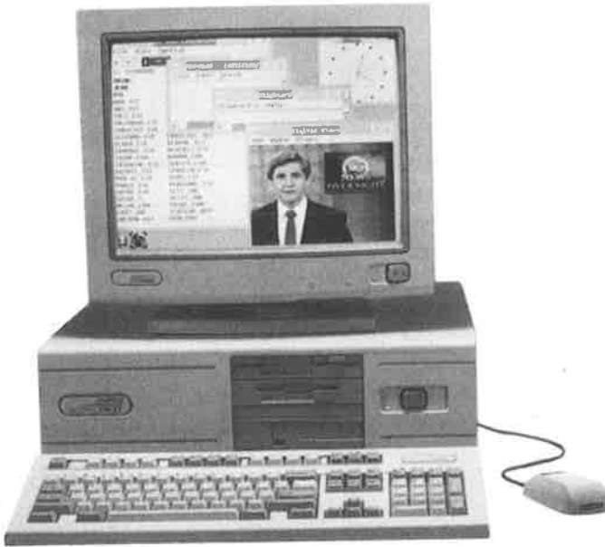
Figura 7.7 Ejemplo de ventanas creadas en un monitor VGA, incluyendo en una de ellas la señal proveniente del reproductor de videodiscos. Este ordenador Compaq está equipado con una tarjeta DVA de VideoLogic.
