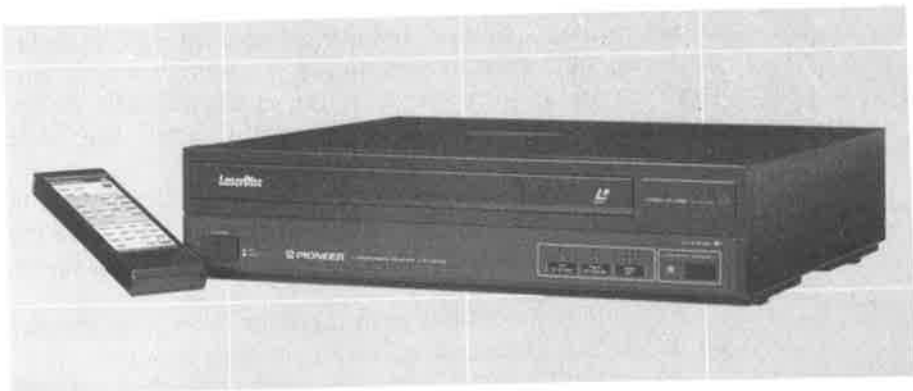
Figura 1.13 Reproductor de videodiscos Laservisión. Modelo LD- V2100 de Pioneer.
